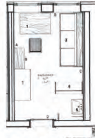
Grundriss eines Einzelzimmers aus dem Entwurf von 1963 1: Arbeitstisch; 2: Stuhl; 3: Bett-Couch; 5: Waschisch; 7: Schrank; 8: Doppel-Ablage; 9: Tisch
